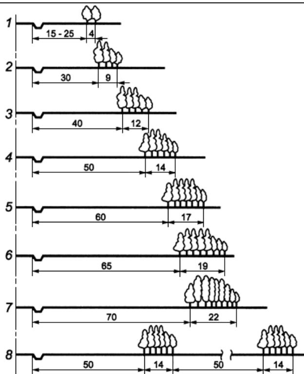
Объемы снегоприноса: 1 - 25 м<sup>3</sup>/м; 2 - 50 м<sup>3</sup>/м; 3 - 75 м<sup>3</sup>/м;
